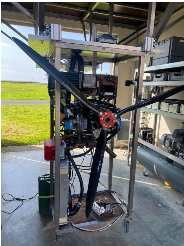
Abbildung 1: „Smarter Propeller“ auf dem Antriebsprüfstand bei Helix Carbon
