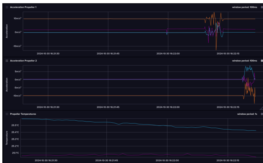
Abbildung 3: Zeitverläufe der Sensordaten im ALBACOPTER® Online-Logging-System
