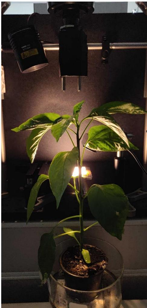
Abbildung 2: Mit der neu entwickelten HyperNIR-Technik verfolgten die Forschenden, wie eine Paprikapflanze Wasser in die Blätter aufnimmt. Mit der mittig über der Pflanze angebrachten Kamera konnten sie im Nahinfrarot-Licht die Vorgänge im Inneren der Pflanze beobachten. © Jan Stegemann
