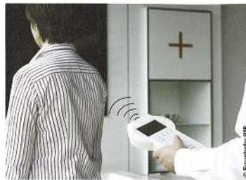
Da sich der Sensor mit seiner integrierten Antenne im Herz nur längs ausrichten lässt, muss er seitlich am Brustkorb ausgelesen werden. Um die Dämpfung des Signals durch Knochen, Körpergewebe und -flüssigkeiten so gering wie möglich zu halten, funkt das System im 10-MHz-Bereich. Es steckt in einer biokompatiblen Polymerhülle, die – im Gegensatz zu Metall – Funkwellen nicht abschirmt, sondern passieren lässt. www.fraunhofer.de
