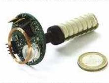
Der Sensor ist mit dünnen Eisendrähten durchzogen, die in regelmäßigen Abständen angebracht sind. Bild: Fraunhofer IMS
