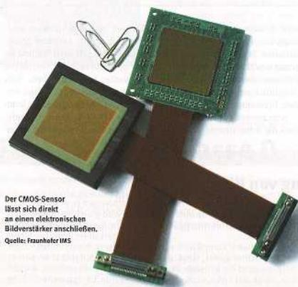
Der CMOS-Sensor lässt sich direkt an einen elektronischen Bildverstärker anschließen. Quelle: Fraunhofer IMS
